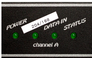
rys 1. Wskaźniki na płycie czołowej konwertera DELTA-2.
